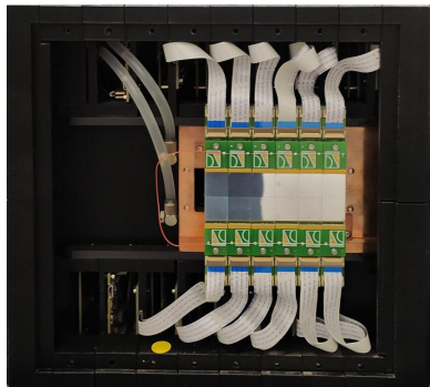
Фигура 1: Снимка на детектора TimePix с неговата охлаждаща система.
